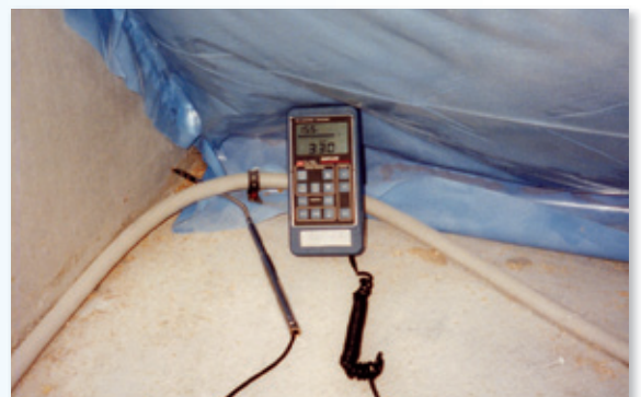
Leckageortung mit dem Anemometer
